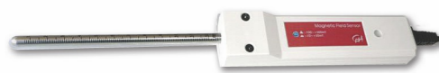
Figuur 11 Met een magneetveldsensor kun je de magnetische veldsterkte meten in een punt van het veld. De sensor bevindt zich in het uiteinde van het pijpje.
