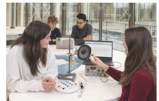
Figuur 9 Een toongenerator levert harmonische elektrische trillingen die een luidspreker kunnen laten trillen.
