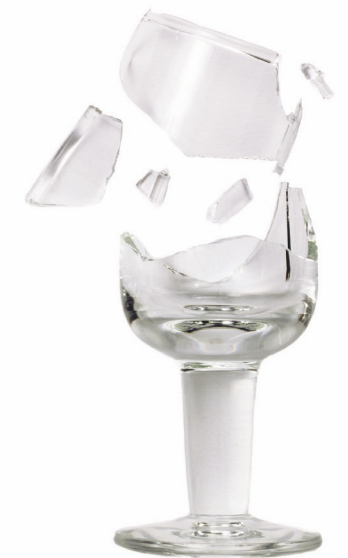
Figuur 85 Door resonantie geknapt
