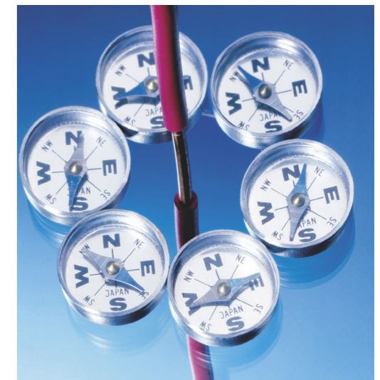
Figuur 14 Stroomdraad loodrecht op een doorzichtig blad met kompasjes
