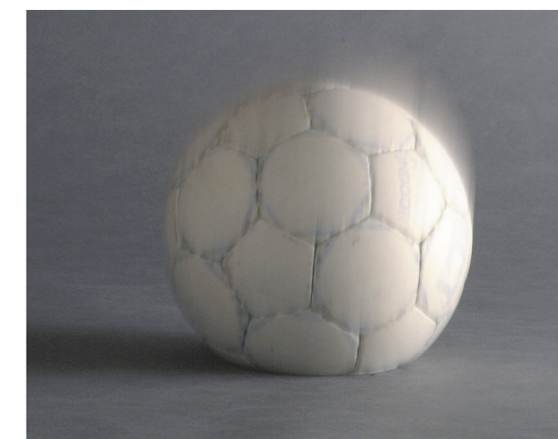
Figuur 33 Een stuitende bal wordt altijd een beetje ingedeukt.
