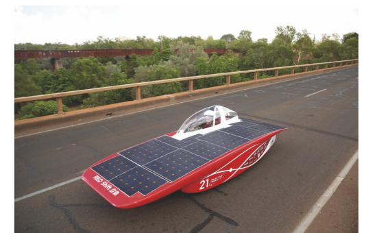
Figuur 7 Zuiniger rijden lukt door de luchtwrijving te minimaliseren door een optimale stroomlijn.
