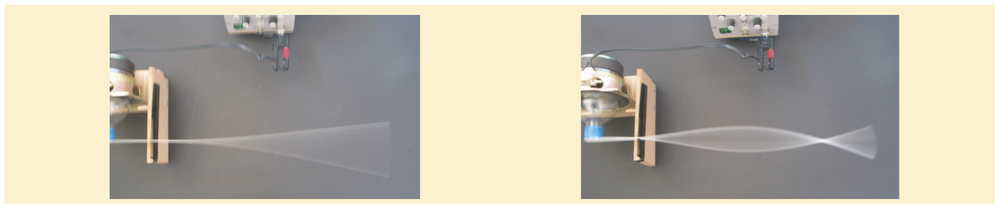
Figuur 67 In een aan één kant vastgeklemd staaf of lat bevindt zich bij het vastgeklemd uiteinde altijd een knoop en bij het losse uiteinde een buik.
