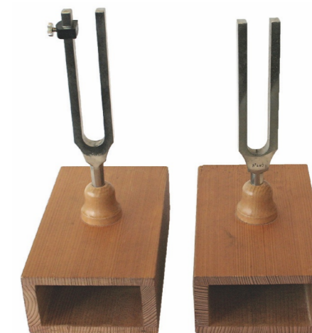
Figuur 41 Twee aangeslagen stemvorken laten zwevingen horen.
