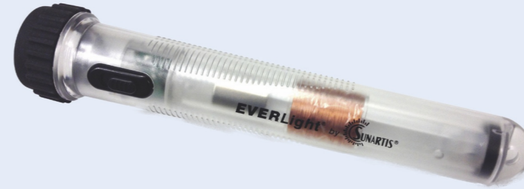
Figuur 94 Schudlamp. De magneet bevindt zich links van de koperen spoel. Bij het schudden schuift de magneet door de koperen spoel heen en weer.
